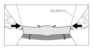
純正バンパー (両面テープで貼りつける部分) の汚れや油分を、脱脂剤を 用いて十分に落としておきます。
