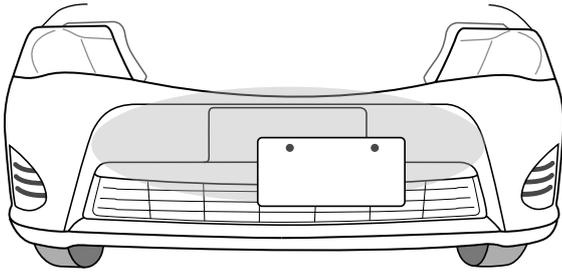
3. ナンバープレートを止めているネジをボックスレンチを用いて外し、ナンバープレートを取外します。
