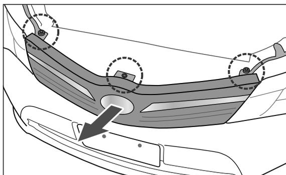
1. ボンネットを開け、図の位置のネジとキャップを3カ所外します。
