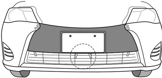
4. 本製品をはめ込み、ナンバープレートを取付け仮止めします。位置を合わせ、中央部から両面テープの剥離紙をゆっくりと剥がしていきます。
